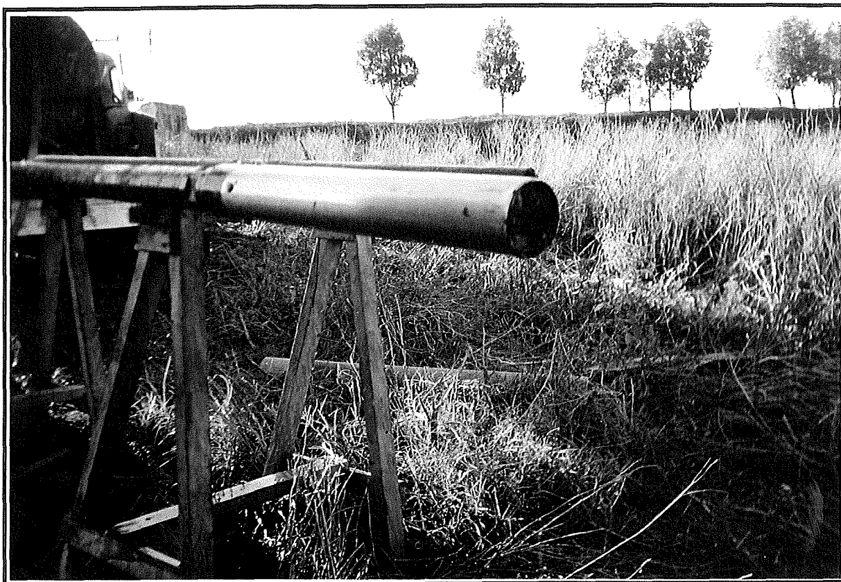
FOTO 5 - Particolare della fustella contenente il campione indisturbato appena prelevato.
