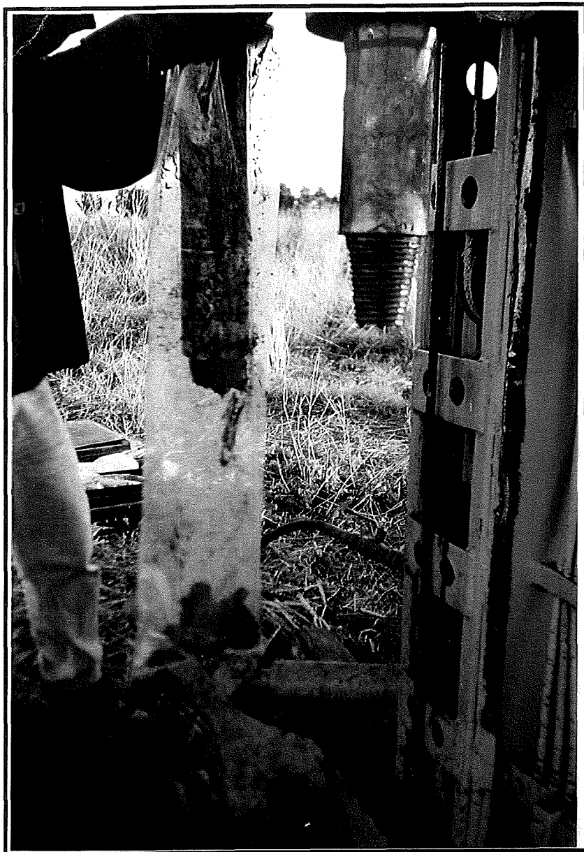
FOTO 1 - Estrazione della campionatura dal carotiere.
